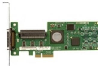
**Figura 4-21:** Controladora SCSI-320 para conectar con el dispositivo Scalar 100.
