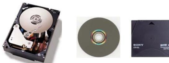
Figura 2-1: Disco duro, disco óptico y cinta magnética.
