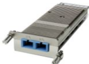
Figura 2.2.2: Xenpak-10GB-LR com l'instal·lat al PIC per a la connexió a 10 Gbps de la segona fase del projecte
