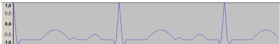
**Figura B.7** — En la figura se muestra el resultado de almacenar la señal ECG en un fichero WAVE por el método que utiliza todo el rango de valores disponible para un archivo WAVE.
