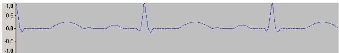
**Figura B.6** — En la figura se muestra el resultado de almacenar la señal ECG en un fichero WAVE por el método que conserva la línea isoeleétrica sobre los 0 mV.
