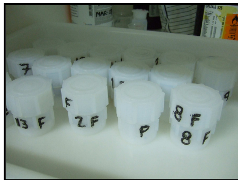
Fig. 4.3. Imatge de les bombes de tefló utilitzades per a la digestió. Foto realitzada el 01/04/08 a les dependències de l'IJA.
