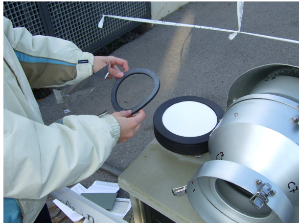
Fig. 4.2. Imatge del canvi de filtre de PM 10 en un captador MCV. Foto realitzada el 08/12/07 a Parc Central.
