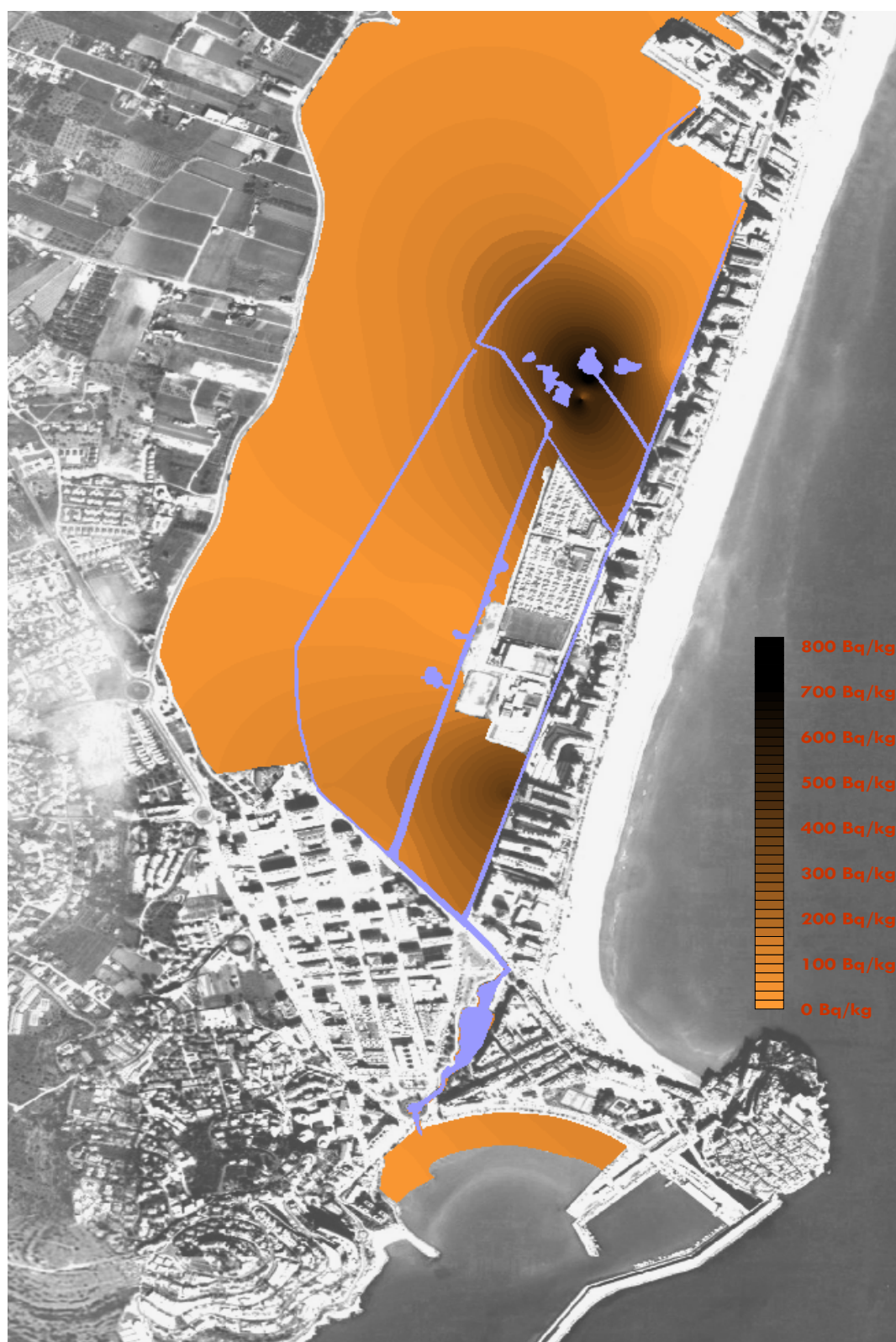
Figura 4.1. Distribució de l'activitat de ^{226}\text{Ra} als sòls de la Marjal de Peníscola a partir de 23 mostres analitzades.
