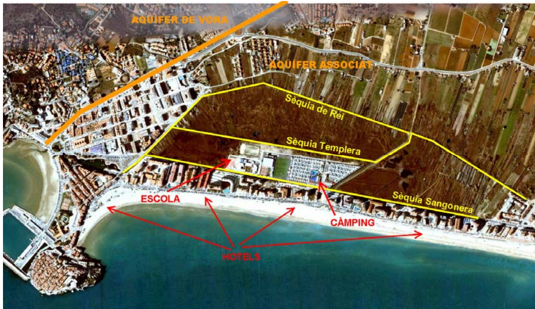
Figura 2.2. Imatge aèria de la Marjal de Peníscola, amb les sèquies principals remarcades (en groc). S'hi esquematitza el límit (en taronja) entre l'aqüífer de base (Vinaròs-Penyíscola) i l'aqüífer de vora (Maestrat), i s'indiquen algunes edificacions properes a la marjalera (Elaboració pròpia a partir d' imatge de Google Earth).
