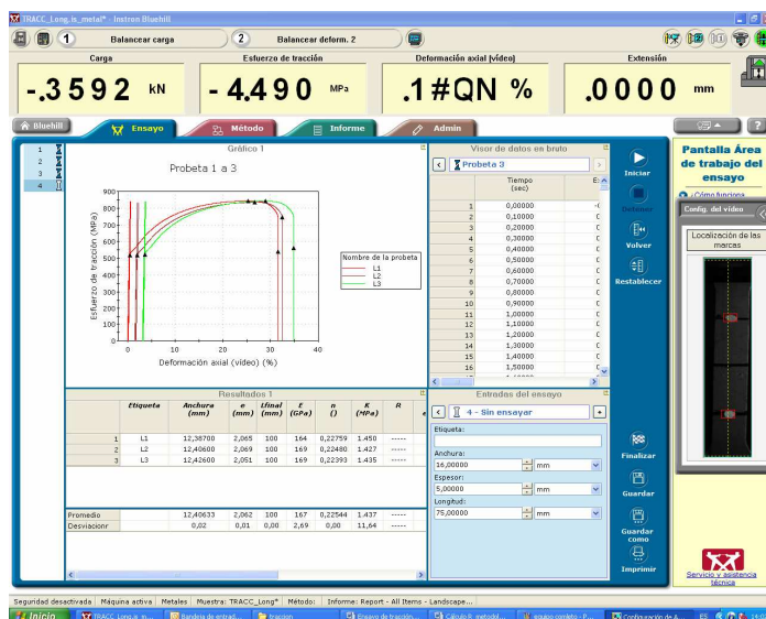
Fig. 5.5- pantalla del programa para ensayo de tracción uní axial. El gráfico resultante de tracción deformación en la parte superior.
