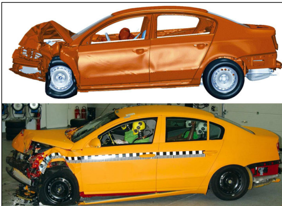
Fig.9.1-Ejemplo simulación de impacto de un vehículo, imagen superior simulación, imagen inferior prueba real, se observa el parecido del resultado final de la deformación entre ambas imágenes.
