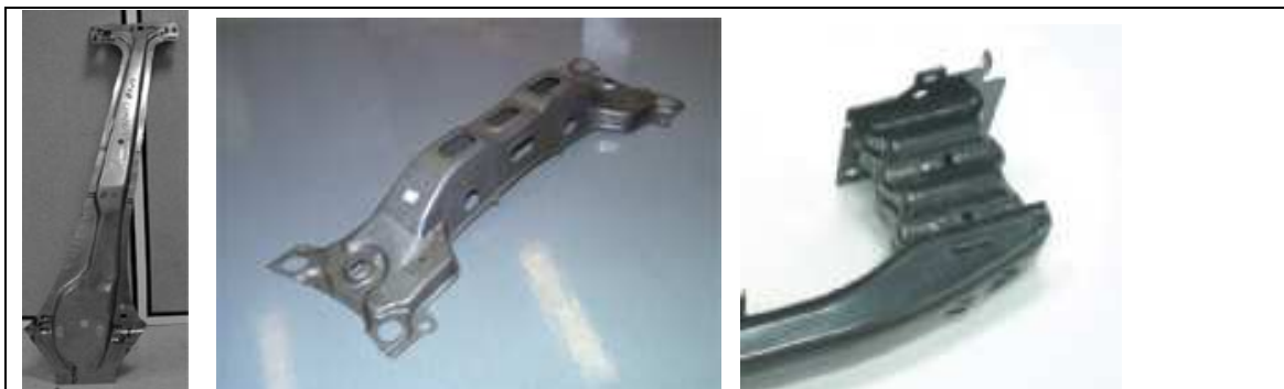
Fig. 1.2- Montantes A, B y aplicaciones de AHSS para absorber impactos.
