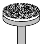
Fig.4.-Dibuix esquemàtic de la preparació de les mostres per ésser observades al SEM.
