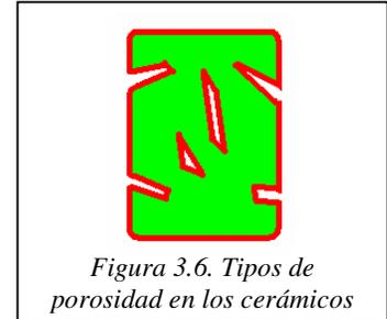
Para asegurar que la porosidad abierta queda totalmente ocupada por agua se sigue el proceso estándar para el cálculo de la densidad que establece la **norma ASTM C373-88** (*American Society for Testing and Materials*). Esta norma establece el proceso de;
