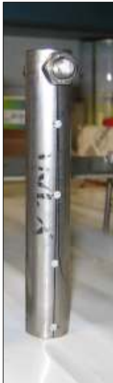
Figura 6.1. A la proveta se li puntegerien quatre forats per tal que el termoparell prengués contacte.
