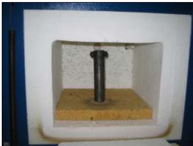
Figura 4.9. Barra d'acer AISI 1045 dins la mufla, aquesta a baixa temperatura (30°C).
