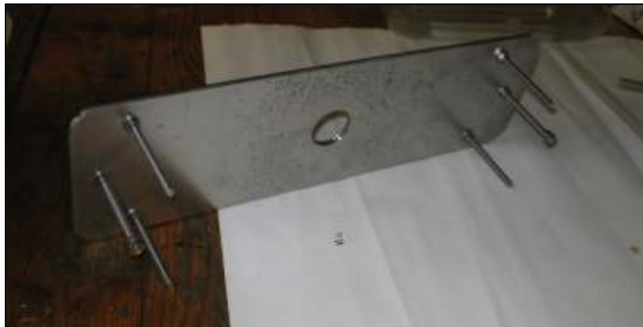
Figura 4.4. Passamà, en el centres s'hi troba situat el forat per on s'hi passaran les barres que quedaran subjectes per a ser refredades.
