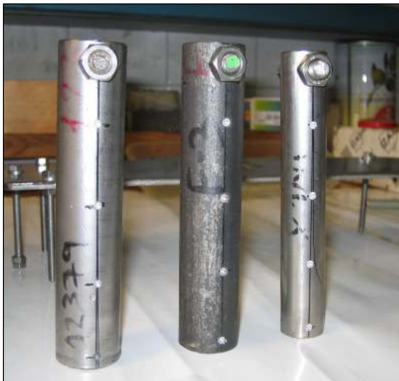
Figura 4.1. D'esquerra a dreta: barra AISI D2, barra AISI 1020 i la de la dreta és la barra d'acer inoxidable AISI que té \varnothing = 20\text{cm} .
