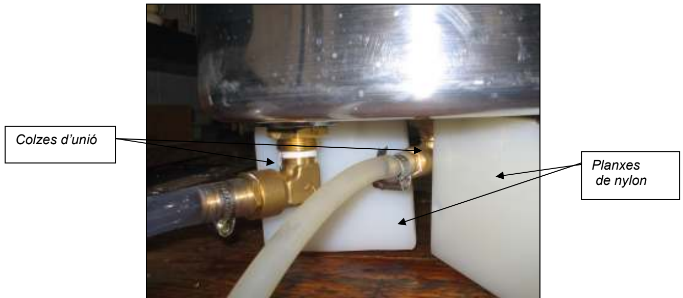
Figura 4.7. L'olla es recolza sobre una taula gràcies a les planxes de nylon. Els colzes connecten les mànegues amb l'olla.
