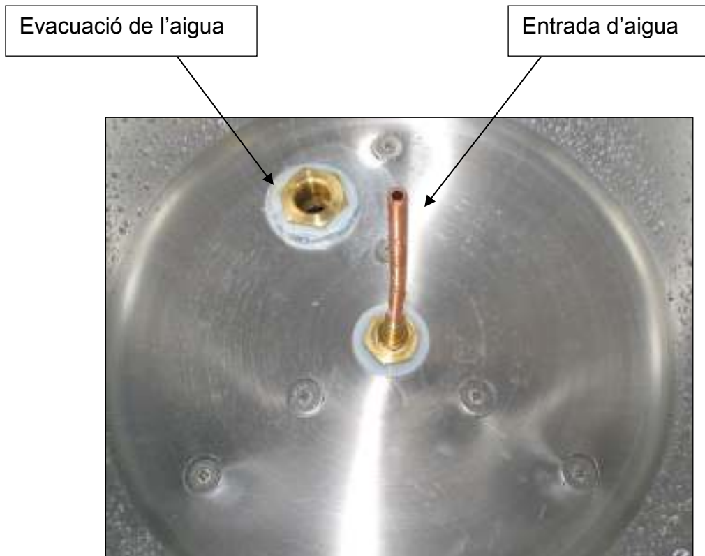
Figura 4.2. Cubeta on es farà el refredament de la barra d'acer.
