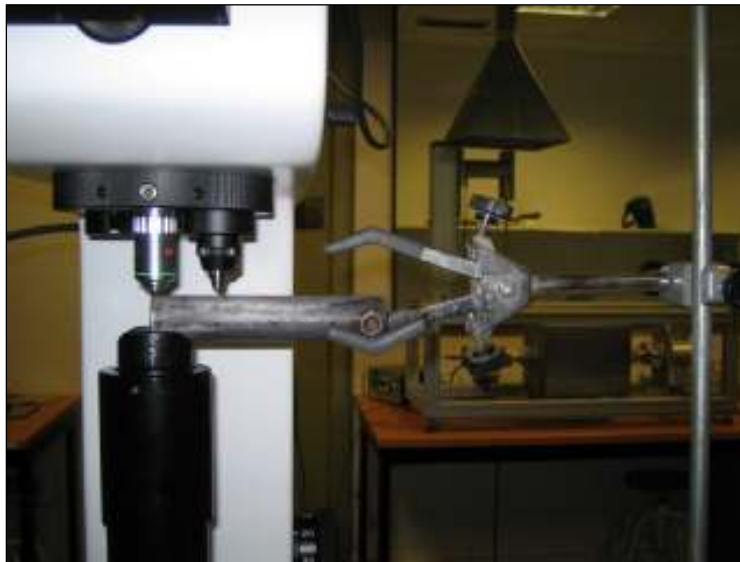
Figura 5.1. Al costat dret del duròmetre s'observa el suport que ens ha permès mantenir la barra en posició horitzontal.
