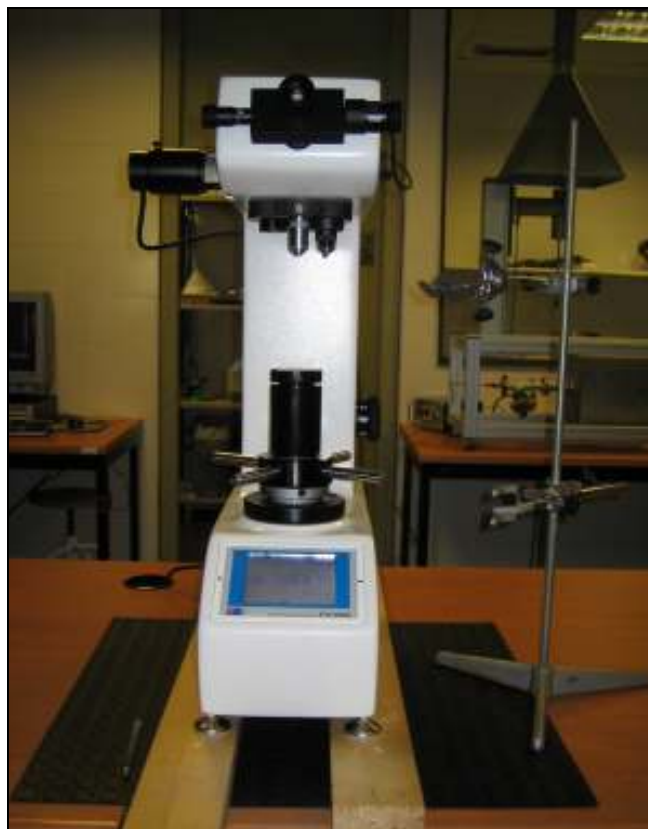
Figura 4.8. Duròmetre Vickers, a la dreta suport per poder aguantar la barra horitzontalment.
