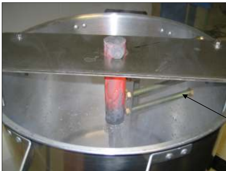
Figura 6.2. La cubeta i la proveta compten amb quatre termoparells per captar les velocitats de refredament.
