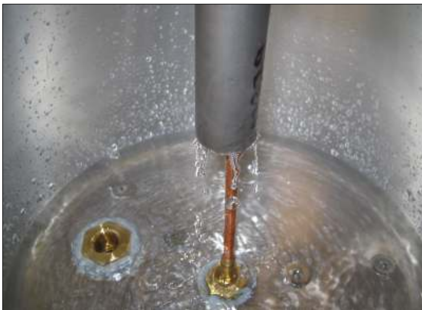
Figura 4.3. L'entrada d'aigua dona lloc a que la barra es refredi per l'extrem.
