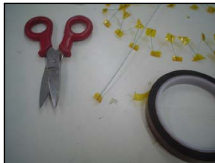
Figura 34. Aislamiento de las soldaduras con Kapton
