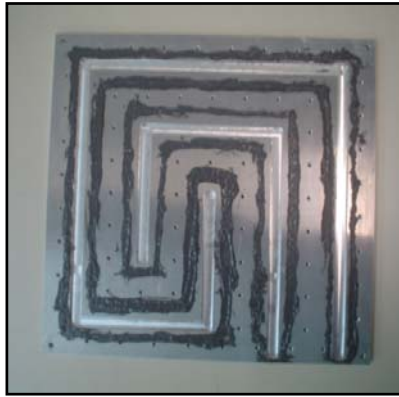
Figura 17. Disposición del cordón de silicona para evitar pérdidas
