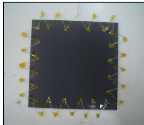
Figura 35. Distribución de los termopares Figura 36. Detalle colocación
