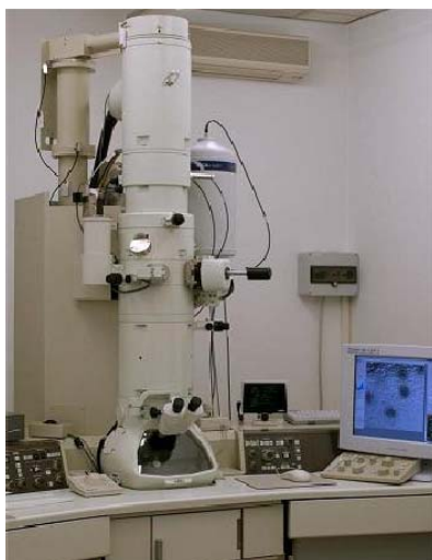
Figura 31: Microscopi electrònic de transmissió de 200 kV JEOL JEM-2011.
