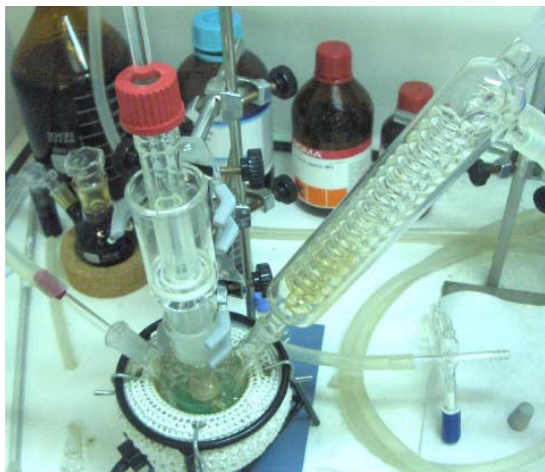
Figura 35: Muntatge experimental: refrigerador a la boca lateral dreta, bombeig d'argó per la boca lateral esquerra i removedor per la boca central.
