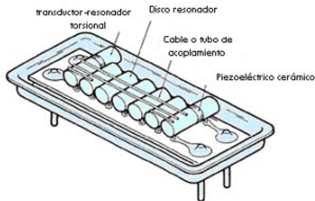
Fig 1.3 - Filtro mecánico de siete resonadores [1.3]
