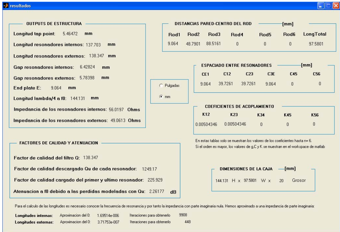
Figura 5.4: Resultados obtenidos de la estructura interdigital mediante el simulador Matlab ®
