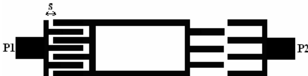
fig. 12 Posició dels ports per a mesurar el factor de qualitat extern.
