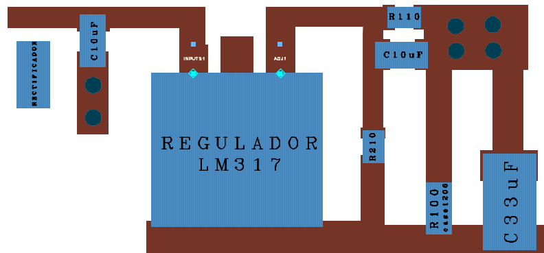
Figura 4.3: Ampliación del conexionado del regulador
