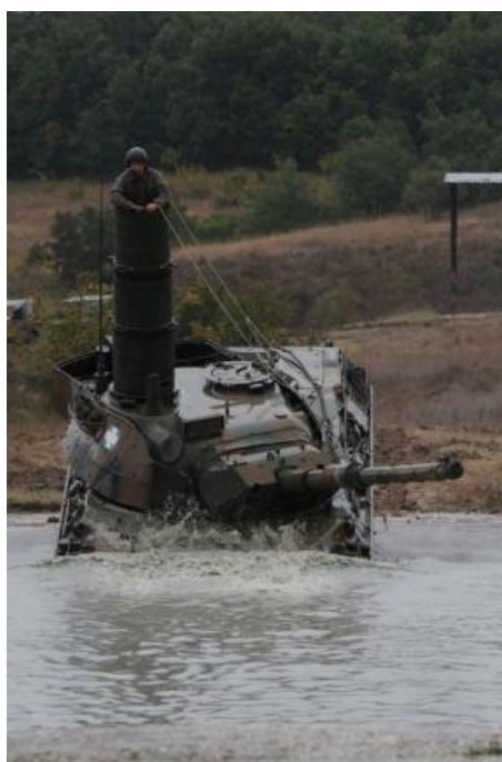
Εικόνα 1.7: Πλήρωμα άρματος μάχης Leopard 1A5 πραγματοποιεί διάβαση υδατινού κωλύματος με την χρήση συσκευής SNORKEL.
