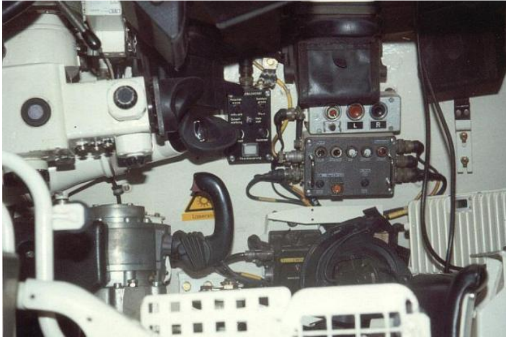
Εικόνα 1.1: Πανοραμικό περισκόπιο αρχηγού TRP.
