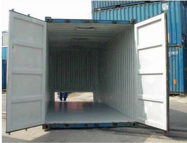
Εικόνα 8. Εμπορευματοκιβώτιο στερεών χύδην φορτίων
