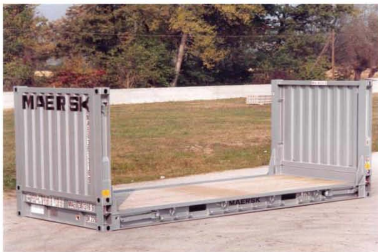
Εικόνα 6. Εμπορευματοκιβώτιο επίπεδη επιφάνεια
