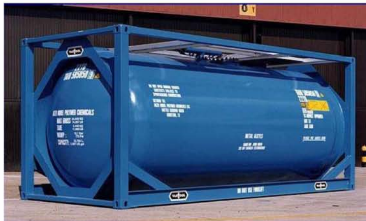
Εικόνα 7. Εμπορευματοκιβώτιο υγρών χύδην φορτίων και συμπιεσμένων αερίων
