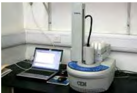
Εικόνα 12CEMMicrowave Αντιδραστήρας με αυτόματο συλλέκτη δειγμάτων
