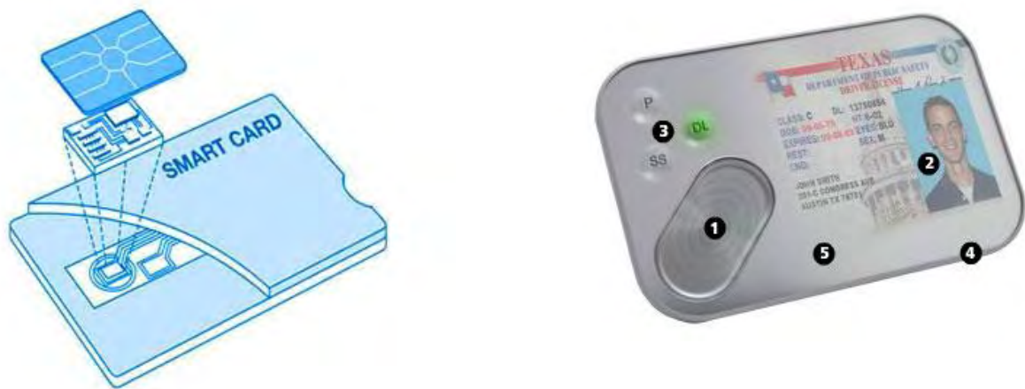
Εικόνες 15 και 16. Μια συνηθισμένη smart card. Μια smart card με ενσωματωμένο σύστημα αναγνώρισης δακτυλικού αποτυπώματος
