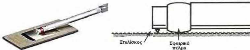
Σχήμα 6.21: Μετακινούμενο στέλεχος-στυλίσκος (αισθητήρας) του τραχυμέτρου Surtronic 3+.
