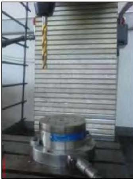
Σχήμα 9.1: α) Διάταξη δραπάνου-δυναμομέτρου β) Κατεργασμένο δοκίμιο και οπές πειραμάτων (οι οπές χωρίς αρίθμηση χρησιμεύουν για την στήριξη του δοκιμίου στο δυναμόμετρο).
