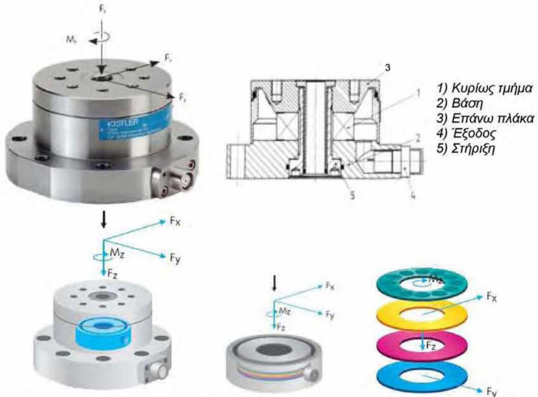
Σχήμα 6.15: 4-αξονικό δυναμόμετρο 9272 σε τομή και οι δακτύλιοι χαλαζία. [187]
