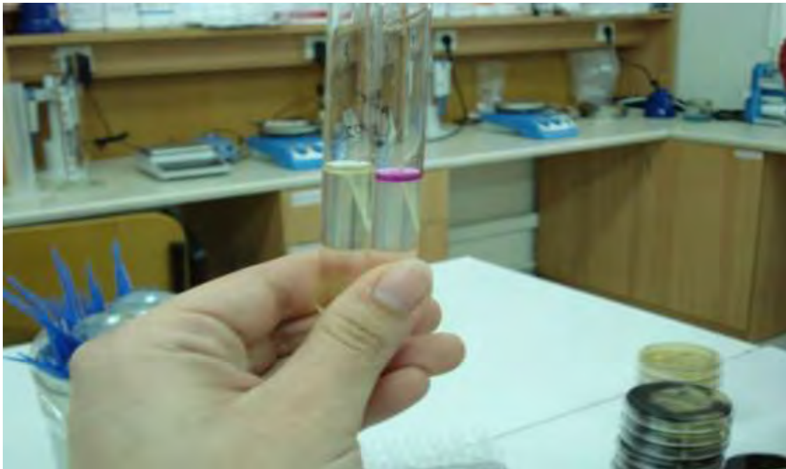
Εικόνα 7 - Ινδόλη(+), δεξιά και Ινδόλη (-), αριστερά
