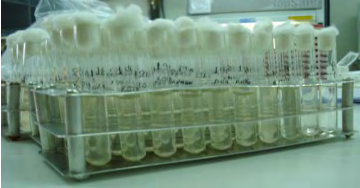
Εικόνα 4 - Μετά την επώαση και πριν την προσθήκη του αντιδραστηρίου Kovac's.
