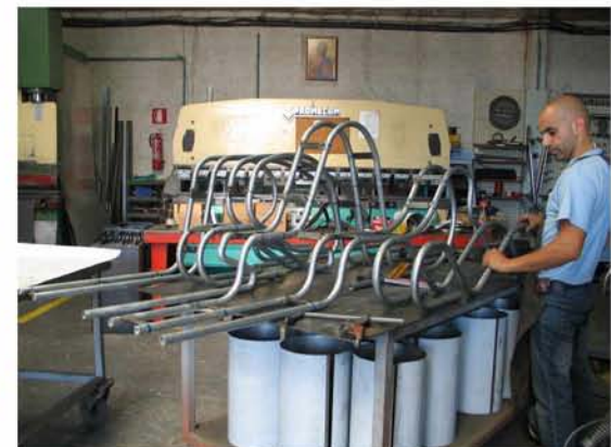
Κατασκευή μεταλλικού σκελετού
