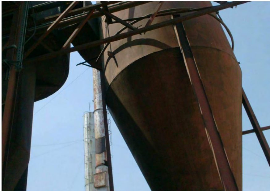
Εικόνα 2.3: Κυκλώνας συγκράτησης στερεών – σκόνης (ΕΛΚΕ Α.Ε. Greece 2010)
