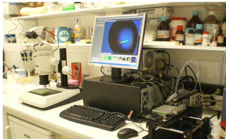
Εικόνα 3.5: Ρομποτικό μηχανήμα κρυσταλλώσεων OryxNano (Douglas Instruments) του εργαστηρίου Δομικής Βιολογίας και Χημείας, ΕΙΕ.
