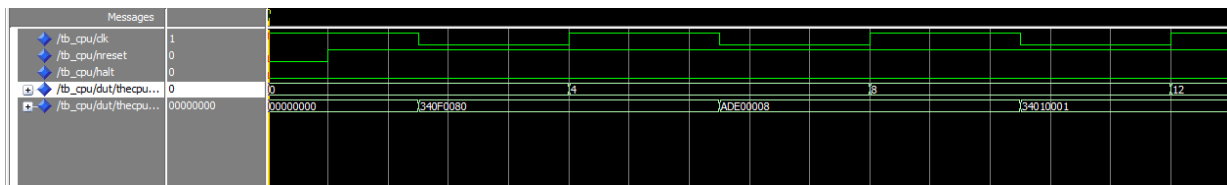
Εικ. 4.2-3: Αρχικοποίηση του επεξεργαστή με τη φόρτωση των εντολών του προγράμματος στη μνήμη εντολών.
