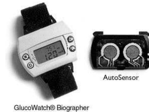
Εικόνα 3.3: Το ΣΣΜΓ GlucoWatch Biographer.
