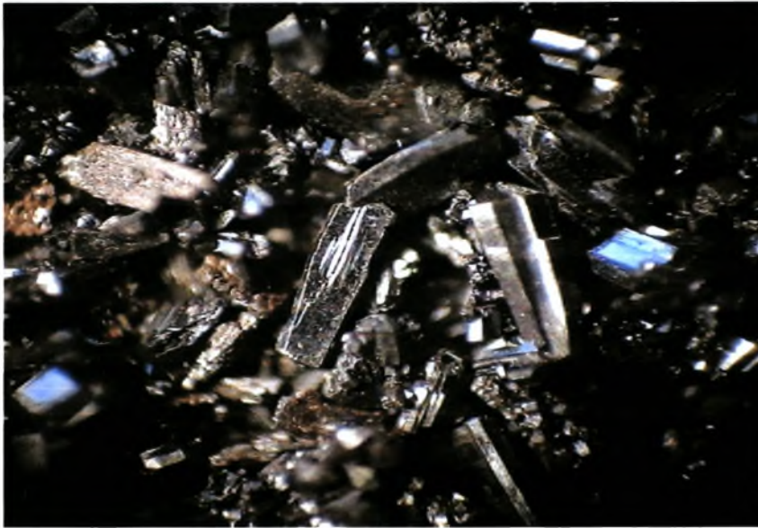
Σχήμα 1.5 Φουλλερενικοί κρύσταλλοι του άνθρακα. Κάθε κρύσταλλος μονάδα αποτελείται από 60 άτομα άνθρακα.
