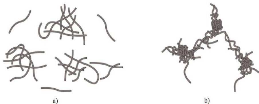
Figura 2.13 – Representação de nanotubos de carbono dispersos e aglomerados; (a) dispersos, (b) aglomerados [33]
