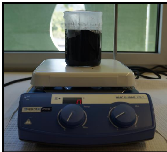
Figura 4.4 – Dispersão de nanotubos de carbono na solução aquosa
