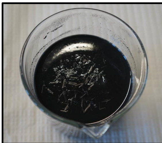
Figura 4.7 – Solução aquosa com nanotubos e fibras curtas de carbono
