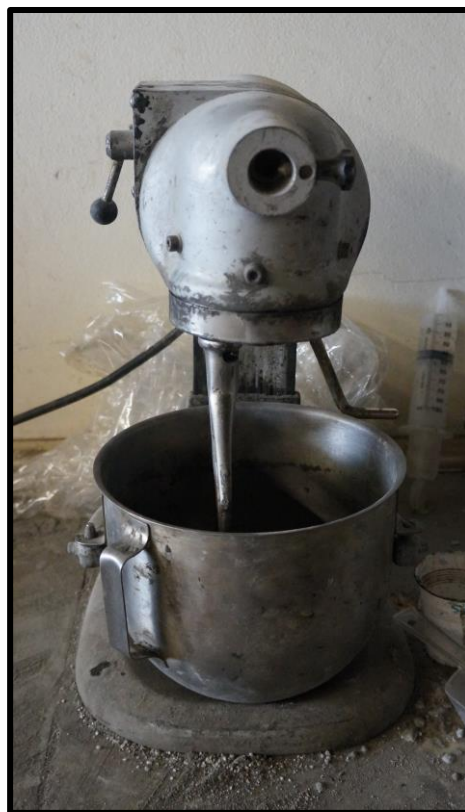
Figura 4.3 – Misturadora de eixo vertical, “flat beater”
