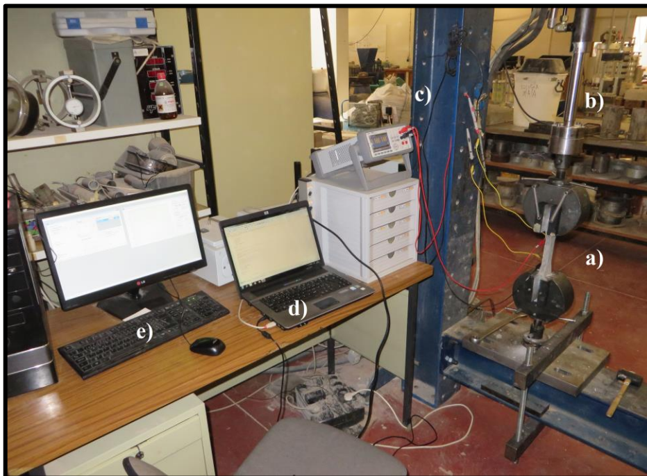
Figura 5.4 – Ensaio de tração cíclico; a) provete nas amarras com eléttodos; b) atuador de carga de 25 kN; c) multímetro digital Agilent 34460a; d) PC com software de análise da resistência elétrica; e) PC com software de análise da carga de Tração uniaxial
