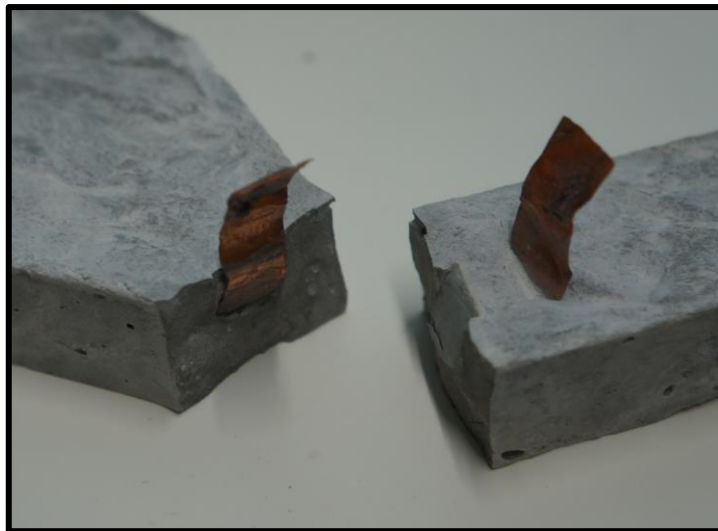
Figura 5.37 – Interior do provete depois do ensaio de tração monotónico
