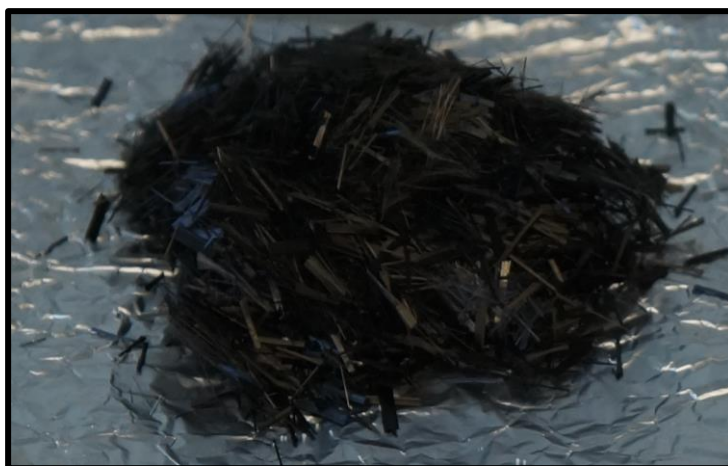
Figura 3.1 – Fibras curtas de carbono utilizadas no trabalho laboratorial
