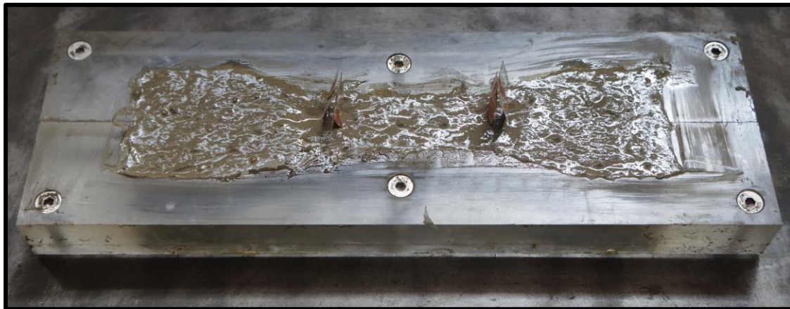
Figura 4.11 – Provette depois de processo de compactação
