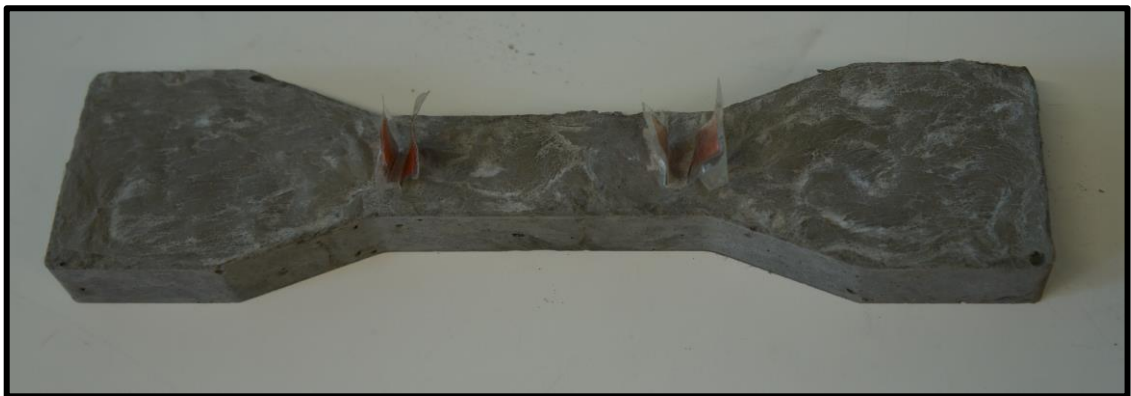
Figura 4.14 – Provete 28 dias depois sob água
