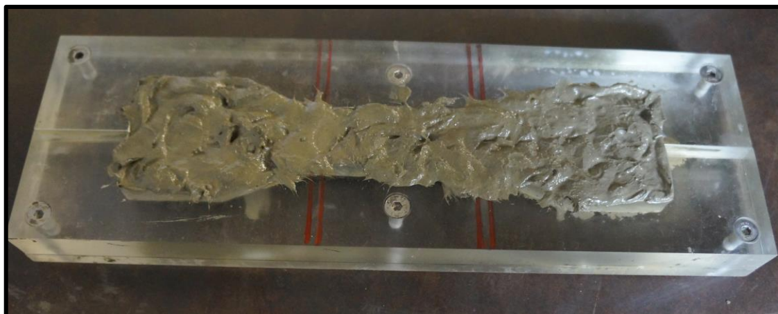
Figura 4.9 – Enchimento de molde com pasta cimentícia
