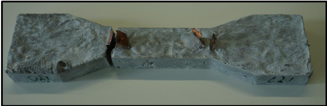
Figura 5.36 – Provete depois do ensaio de tração monotónico
