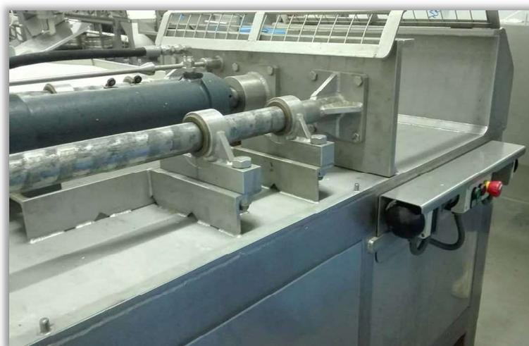
Figura 7 – Imagem ilustrativa de uma prensa utilizada na unidade transformadora Vanibru.
