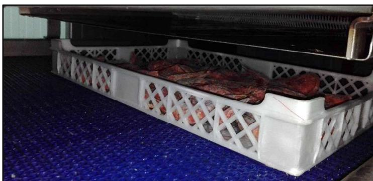
Figura 22 - Imagem ilustrativa referente à colocação do canastro à entrada do último tapete do túnel de congelação.
