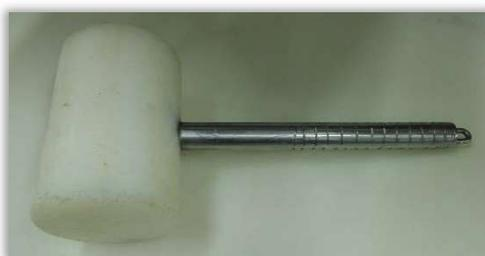
Figura 6 – Instrumento utilizado na desagregação manual.
