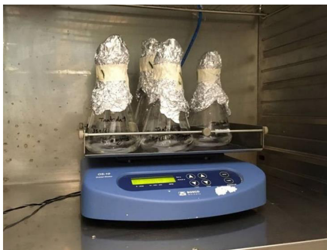
Figura 14- Erlenmeyers de teste em incubadora (Binder) a 37 °C sob agitação a 150 rpm.
