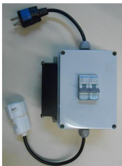
Figura 5.2 – Quadro de transferência.
