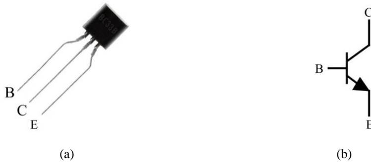
Figura 5.10 – Transistor BC546B da ON Semiconductor [113]: (a) Encapsulamento; (b) Símbolo elétrico.
