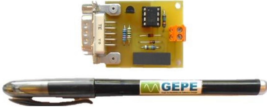
Figura 5.9 – Placa de driver do disjuntor eletrônico.
