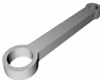
Figura 1.20 – Modelo sólido de uma biela realizado num sistema CAD.
