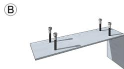
Figura 4.6 - Perspectiva de encaixe metálico (7x25x10cm)
