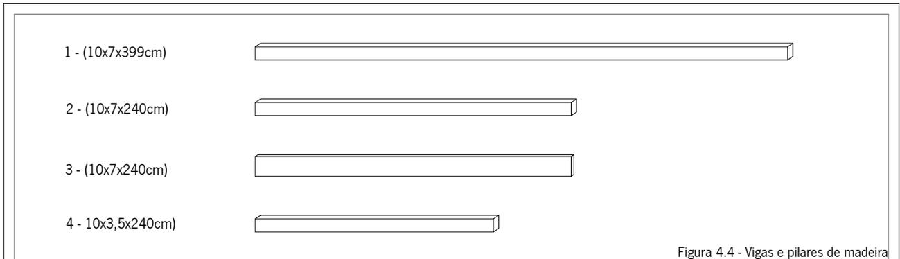
Figura 4.4 - Vigas e pilares de madeira
