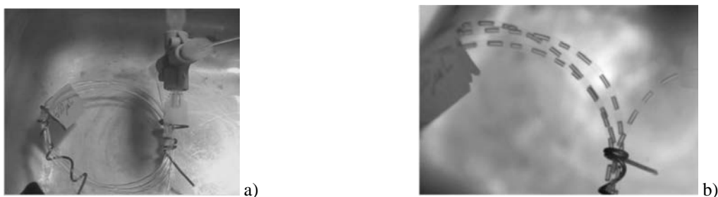
Figura 1 – a) Imagem do microreator tubular imerso num banho ultrasónico, e b) imagem do microreator tubular em fluxo gás-líquido.
