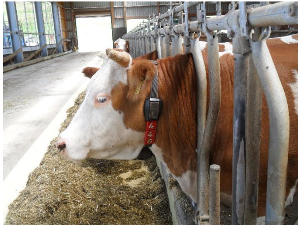
Abb. 2 Gleichzeitige Erfassung von Wiederkauverhalten und Bewegungsaktivität durch Aktiometer und Mikrofon, seitlich am Halsband angebracht
