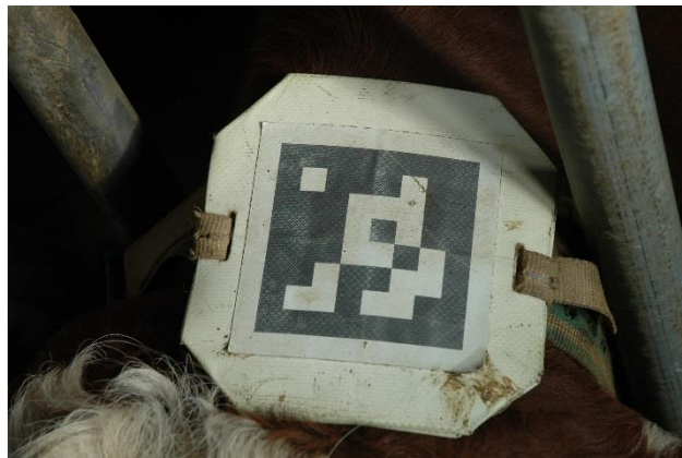
Abb. 12: Beginnende Ablösung der selbstklebenden Marker-Folie von der Unterlage an den Ecken
