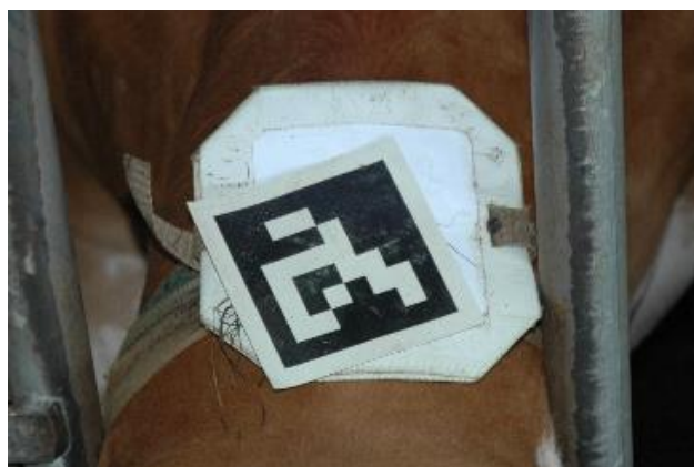
Abb. 13: Vollständige Ablösung der selbstklebenden Marker-Folie von der Unterlage mit Verschiebung
