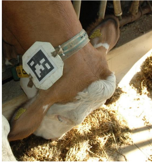
Abb. 14: Einseitiges Ausreißen der Markerfixierung am Halsband
