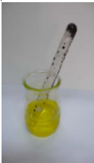
Figura 1. Muntatge experimental. Cal esperar que l'oxigen reaccione amb el ferro humit i l'aigua ascendeixca pel tub.
