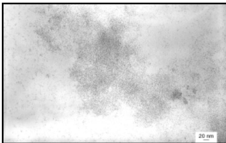
Figura 55. Imatge TEM de nanopartícules de ruteni(0) estabilitzades per 17 preparades en THF (exp.3, taula 22 ).
