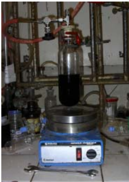
Figura 36. Ampolla de Fischer-Porter que conté una preparació estàndard de nanopartícules a través de l'aproximació organometàlica.
