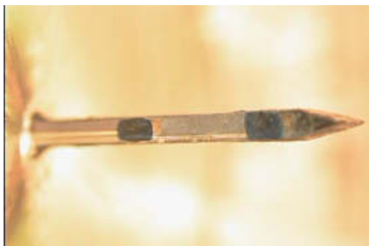
Figura III.15: Detalle de la parte selectiva del microelectrodo.
