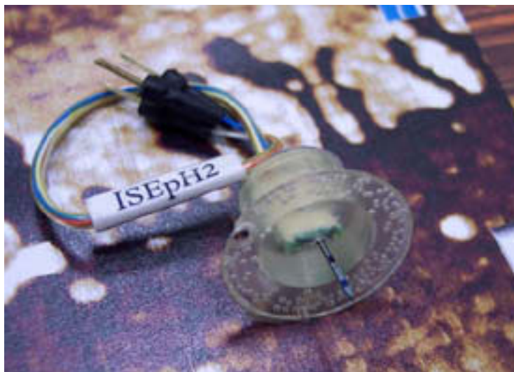
Figura III.14: Fotografía del biochip basado en microelectrodos.
