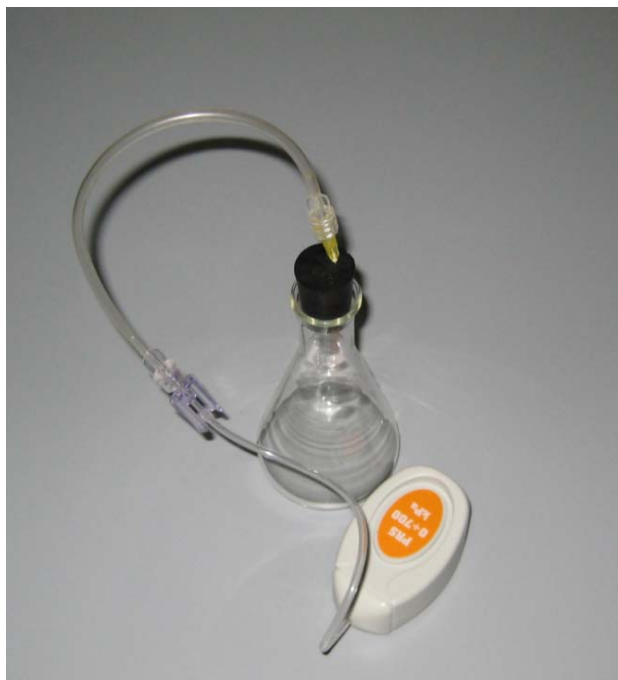
Figura 1. Muntatge experimental per a determinar velocitats de reacció amb equip MBL.
