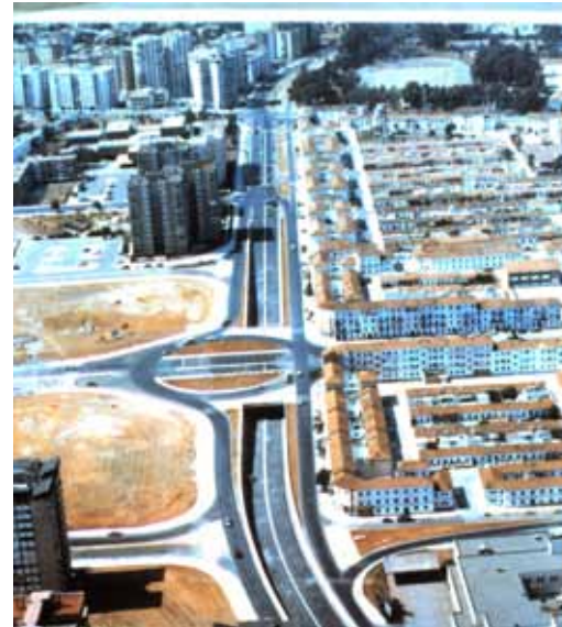
[204] La traza de la Ronda Exterior se concibió como una gran autopista, lo que impedía tomarla como elemento de referencia para la ordenación de las áreas de extensión en su conexión con el resto de la ciudad. El viario medio surgió como el plano conceptual y físico que permitió resolver este grave problema.
