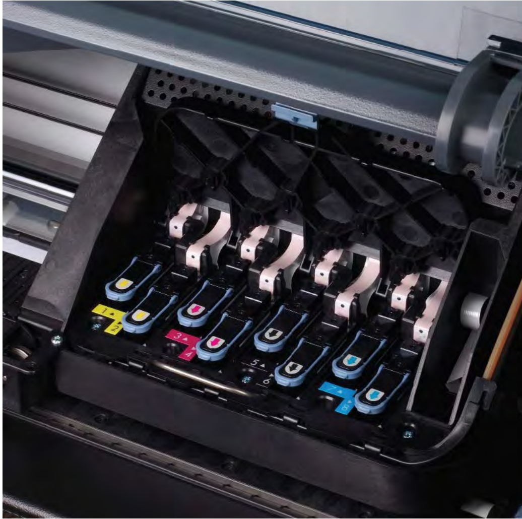
Cabezal y tintas de un plotter de inyección.
