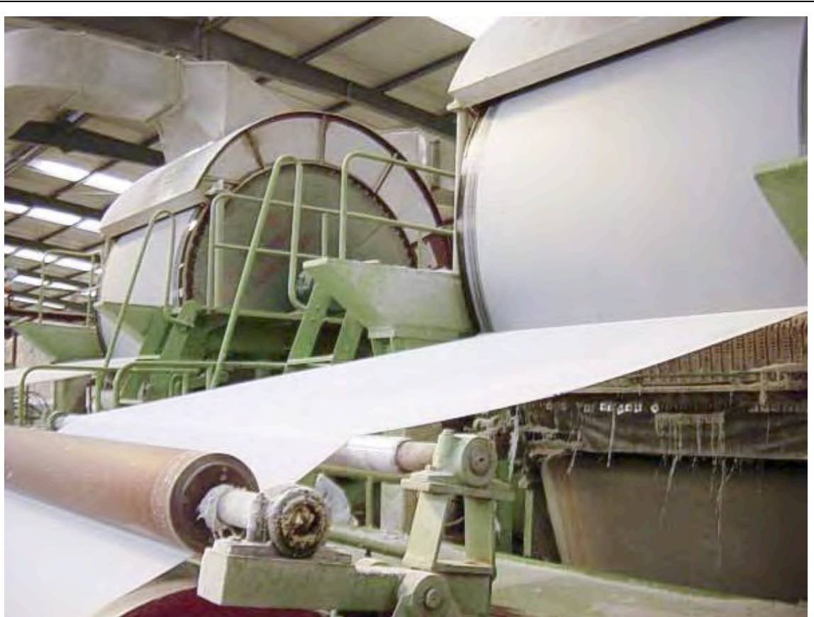
Rodillos de acabado en la fabricación de papel
