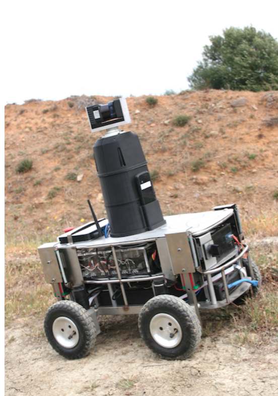
Figura 1: El robot móvil Andábata.
