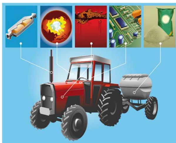
Figura 12. Processos de catàlisi heterogènia relacionats amb el treball agrícola. D’esquerra a dreta: a) tub d’escapament; b) reducció de la capa d’ozó; c) rovellament de la xapa; d) semiconductors dels circuits electrònics; e) fertilitzants artificials (font).
