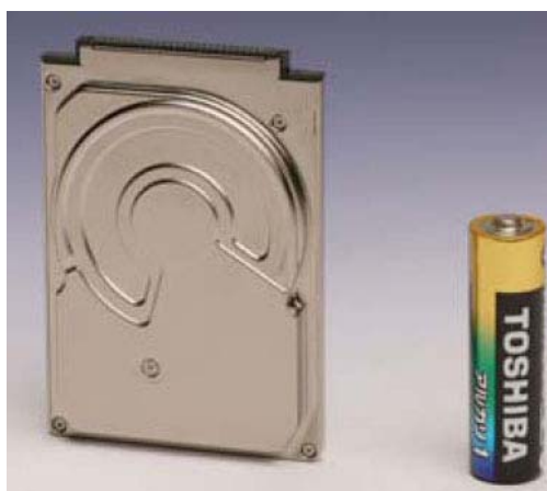
Figura 13. Un disc dur ja pot tenir una mida de pocs centímetres, com és aquest d'un iPod.
