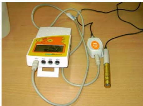
Figura 1. Elèctrode de conductivitat, sensor i consola Multilog-Pro on es mostren les entrades per a les connexions.
