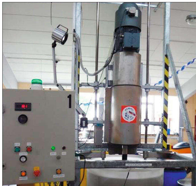
Figur 4. Laboratorie setup til måling af friktionsmodstand på en (begroet) malingscylinder. Sidstnævnte er neddyppet i havvand i den hvide tank og kan ikke ses på billedet. Efter [3].
