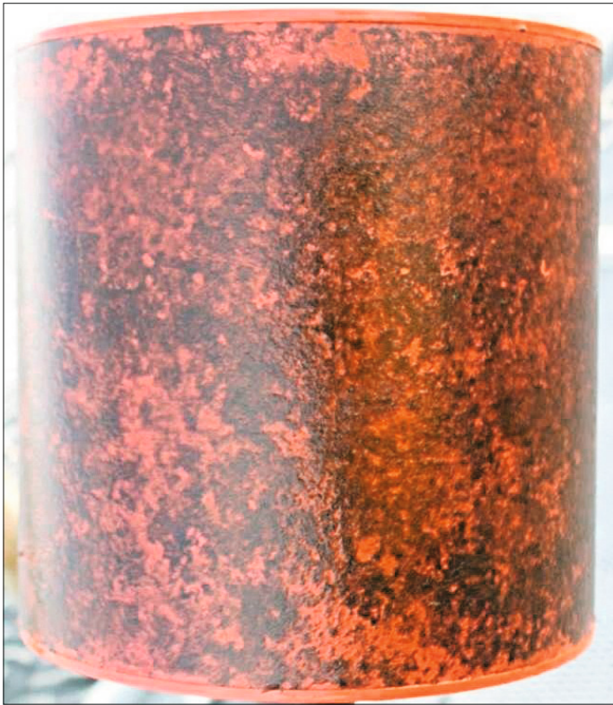
Figur 2. Rotortromler med bundmaling. Billedet viser to forskellige slags bundmaling, efter de har været eksponeret i godt 50 uger i Roskilde Fjord. Det ses tydeligt, at malingen til højre (silicone-baseret slip-let maling med en lille mængde biocid) er væsentligt mindre begroet end malingen til venstre (fluor-baseret slip-let maling uden biocid). Fra [3].
