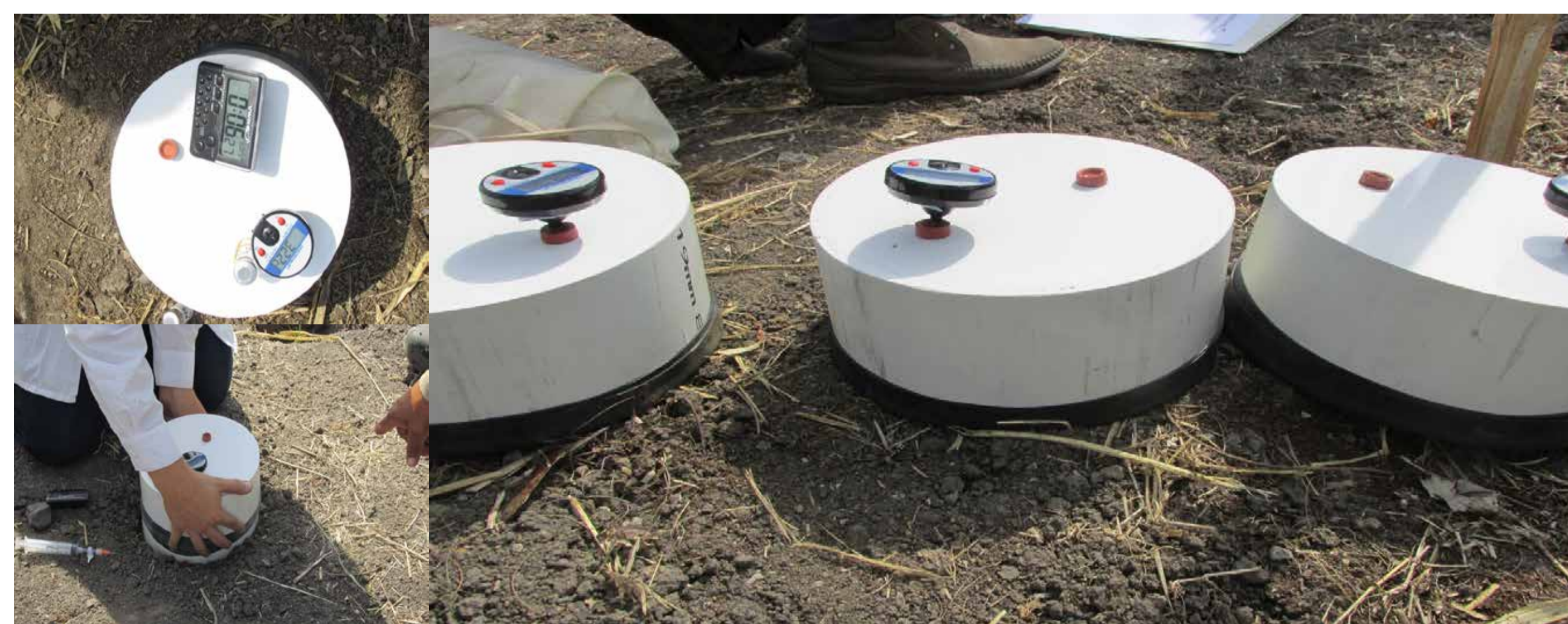
Gráfico 2. Cámaras estáticas cerradas utilizadas para las mediciones.
