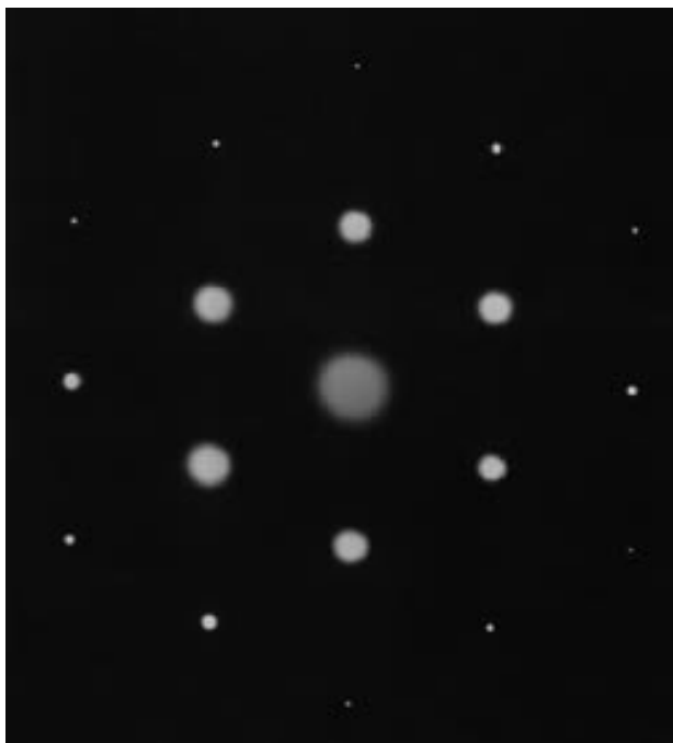
Fig. 7. Figura de difracció obtinguda a partir d'un monocristall de silici (Universitat d'Arizona).
