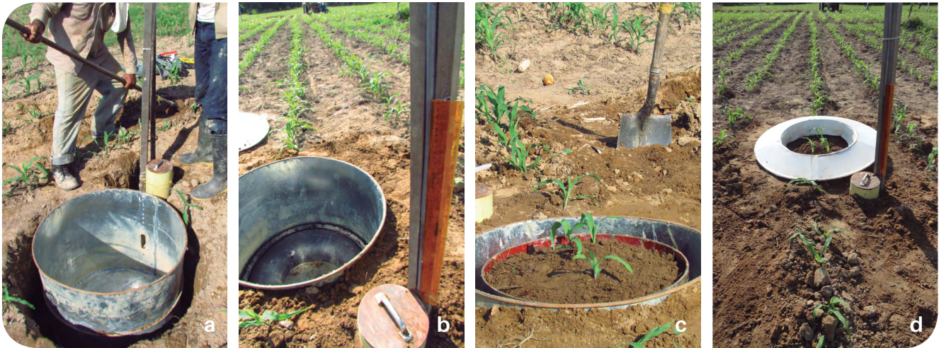
Figura 12. Instalación de un lisímetro neumático de pesada. (a) Ubicación del contenedor externo. (b) Instalación del neumático y unión al piezómetro. (c) Establecimiento de plantas. (d) Instalación del protector.
