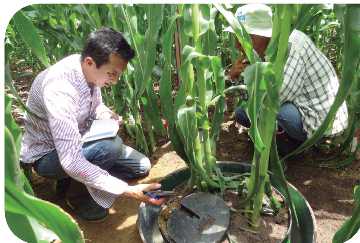
Figura 13. Calibración de lisímetro neumático de pesada con pesos conocidos.
