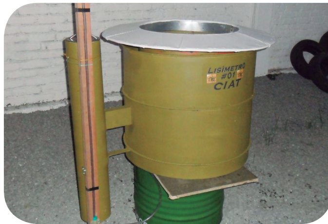
Figura 10. Lisímetro neumático de pesada.
