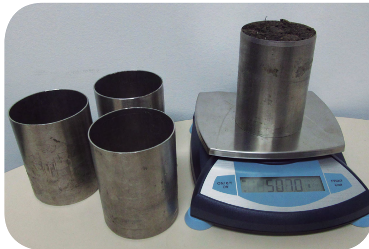
Figura 16. Determinación del contenido de humedad mediante el método gravimétrico.
