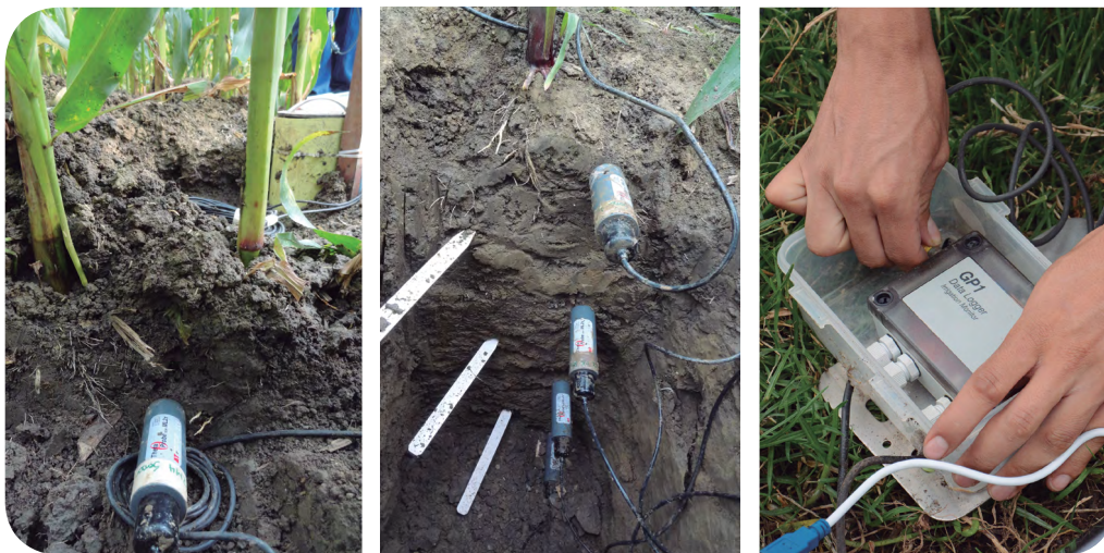
Figura 17. Uso de sensores de humedad para determinar el contenido de agua en el suelo.
