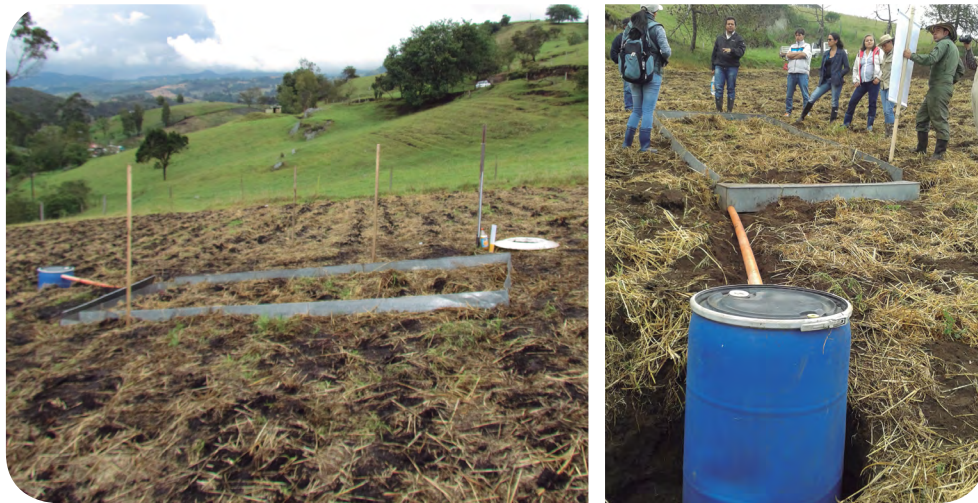
Figura 19. Instalación de parcelas de escorrentía en terreno de ladera.
