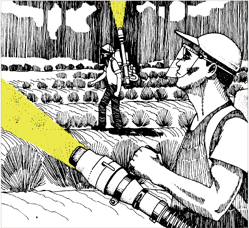
Figure 37. Pulvérisateur pneumatique à dos équipé d'une tête de pulvérisation AU8100 (d'après Micronair). L'élément rotatif est actionné par le flux d'air généré par la soufflerie du pulvérisateur. La tuyère peut être fixée en position haute pour les traitements en dérive contrôlée.
