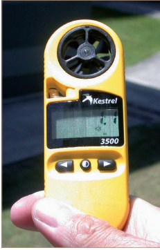
Figure 19. Anémomètre à affichage numérique. Il affiche la vitesse moyenne du vent calculée sur les 30 dernières secondes.
