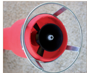
Figure 12. Cône rotatif monté sur l'arrivée d'air d'un pulvérisateur pneumatique à dos (Micron Sprayers).
