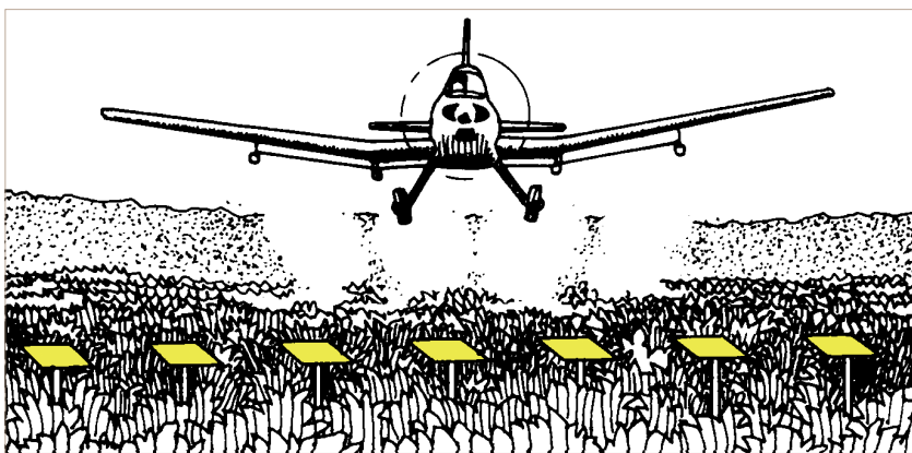
Figure 27. Disposition des collecteurs de gouttelettes pour un épandage aérien de formulation aqueuse (d'après Ciba-Geigy). Les papiers hydro-sensibles sont placés horizontalement sous le passage de l'aéronef.
