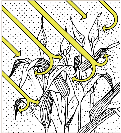
Figure 4. Les avantages des pulvérisations à fines gouttelettes (d'après Hoechst). Elles atteignent la cible par interception et pénètrent bien dans le couvert végétal.
